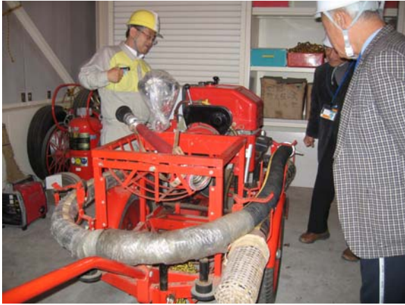
消防車が使えない場合を踏まえ 手押し式ポンプ車も配備
