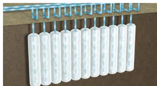
地中の凍土壁のイメージ (廃炉資料館の資料より)
