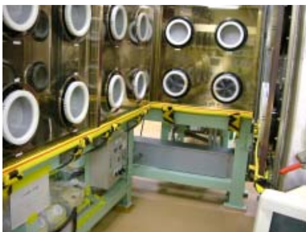
BECKY内のグローブボックス 放射性物質を隔離した状態で分析が行われる
